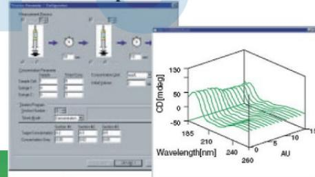
自動滴定裝置可設計依序添加酸 / 鹼液，測量不同 pH 值下蛋白質結構
