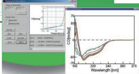
控溫附件可進行變溫實驗，測量蛋白質加熱變性狀態
