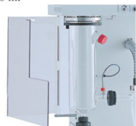
蒸發管具透明保護罩，防止高溫並易於觀察
