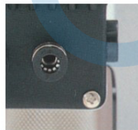
外部氣體入口 (防止溶劑、酸液進入主機)
